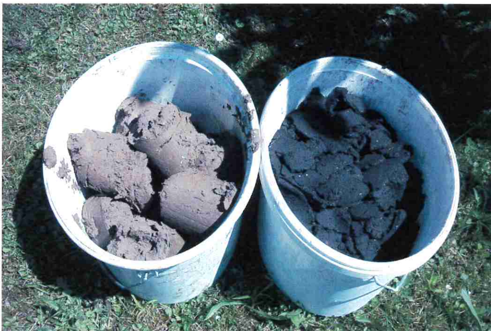
Bild 5: Klärschlamm unbehandelt (rechts) und mit Branntkalk behandelt (links)
