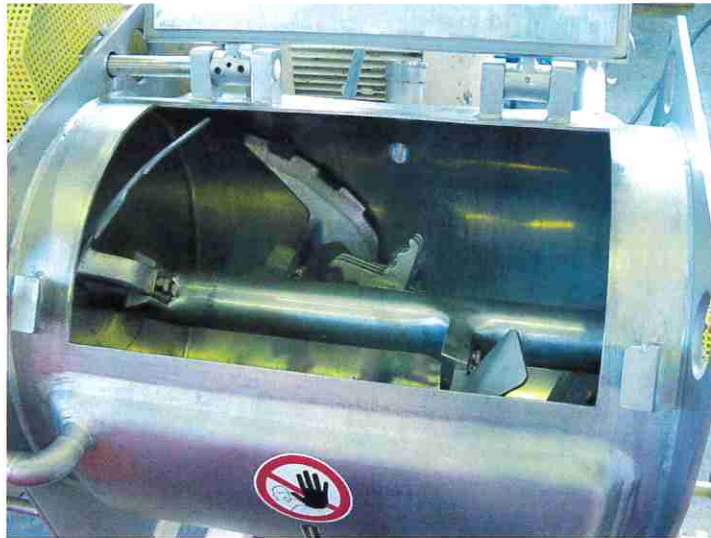
Bild 1: Aufbau des Mixers 2 (Chargenmischer)
